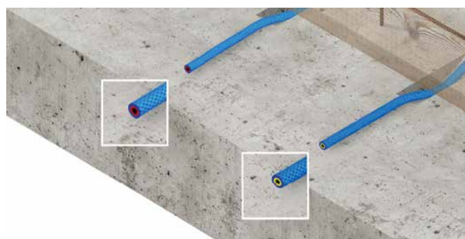
① Befüll- und Entlüftungssystem mit Injektionsschlauch - Detail ① Filling and venting system with injection hose - detail
